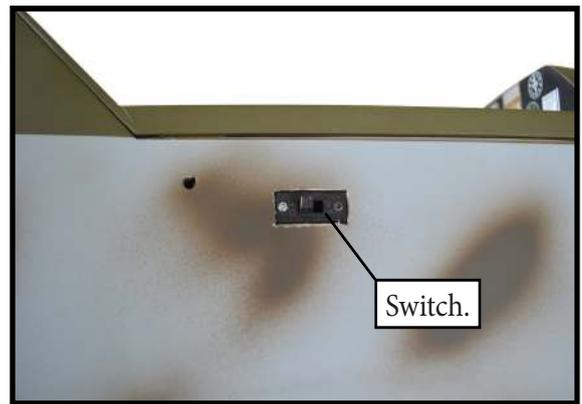
**INSTALLING THE ENGINE SWITCH.**
