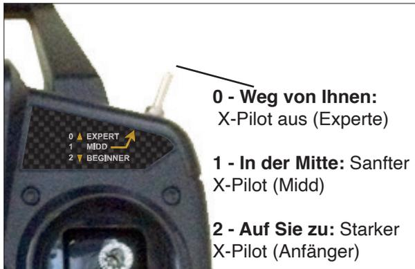
Das Flugzeug wird mit vorinstalliertem X-PILOT geliefert, um das Fliegen leicht zu steuern. Der Schalter verfügt über 3 Stufen zur Steuerung des X-PILOT.
