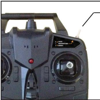
Um einfaches Fliegen zu ermöglichen, wird das Flugzeug mit vorinstalliertem Kreisel (Gyro) geliefert. Um den Kreisel einzuschalten, schieben Sie den Knüppel in die Stellung "Beginner". Um den Kreisel wieder auszuschalten, schieben Sie den Knüppel Richtung "Experte". Die Mittelstellung ermöglicht eine schwächere Kreiselwirkung.
